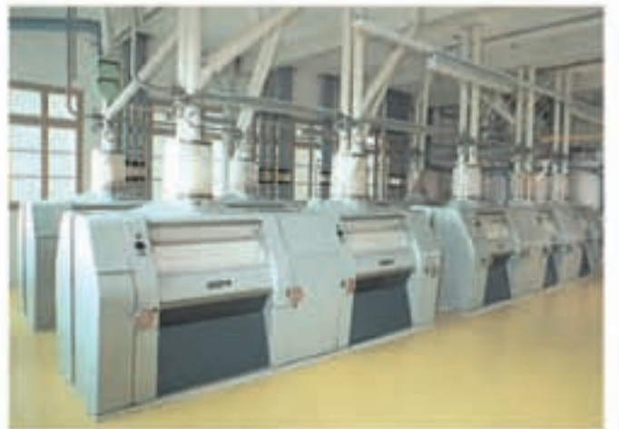
自动化AIRTRONIC MDDK四辊磨粉机在一个磨粉机楼层。
