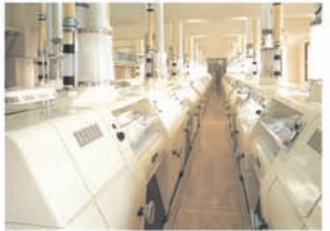
在一个电脑化580吨/24小时面粉厂的磨粉机楼层，装备了AIRTRONIC MDDK四辊磨粉机，具有磨膛提料和连体罩壳结构。
